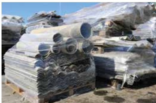
Azbestni odpadki so zdravju izredno škodljivi, zato je treba z njimi ravnati pazljivo in jih oddati na deponijo. / I rifiuti di amianto sono estremamente dannosi per la salute, devono essere trattati con attenzione e smaltiti in discarica. (Foto: Marjetica Koper)
