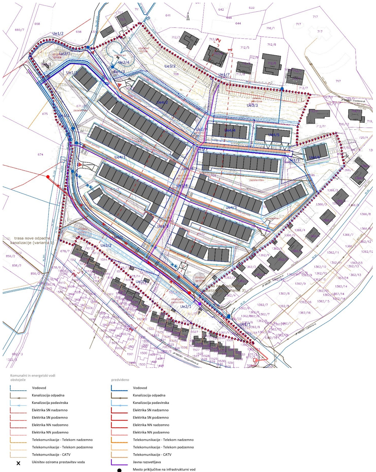
Slika 15: Prikaz ureditev glede poteka omrežij in priključevanja na GJI ter grajeno javno dobro
