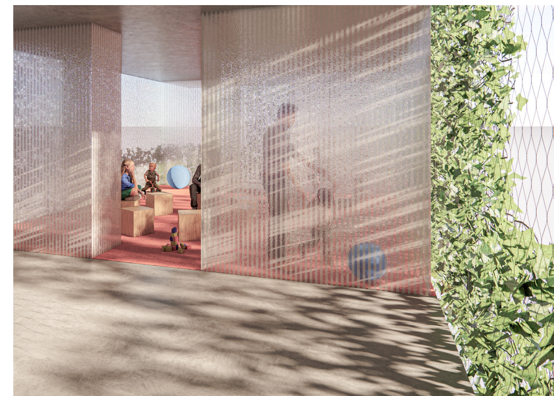
Delno zaprtje s stenami iz večslojnega polikarbonata - lexan. Tako je možna uporaba tudi v slabem vremenu.
