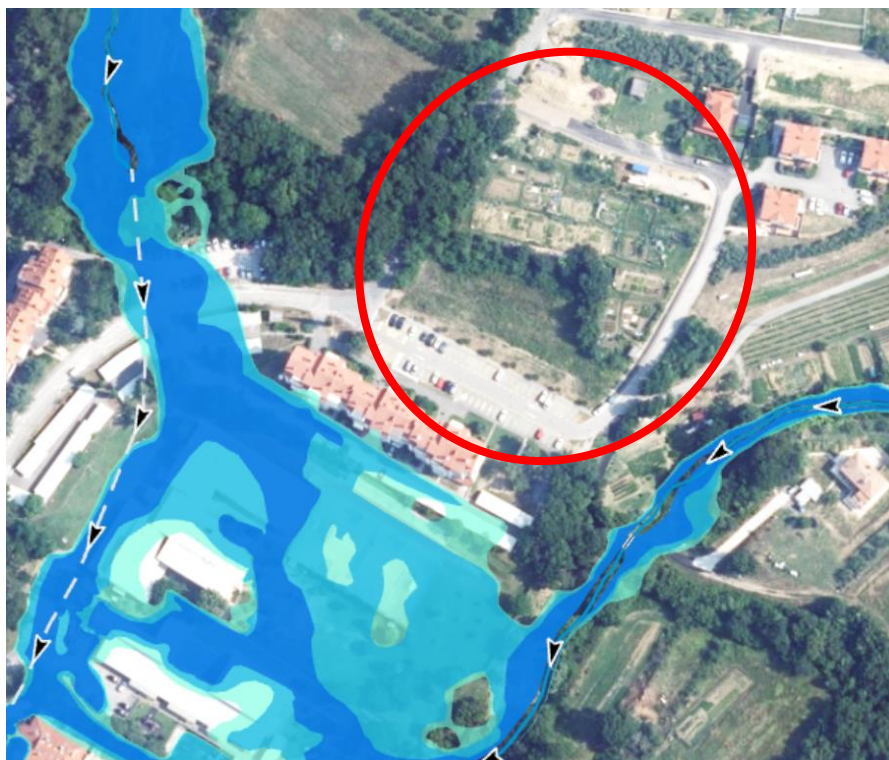
Slika 1: Širše območje umestitve predvidenega posega in obstoječe poplavno stanje na obravnavanem območju (vir: Atlas voda)
