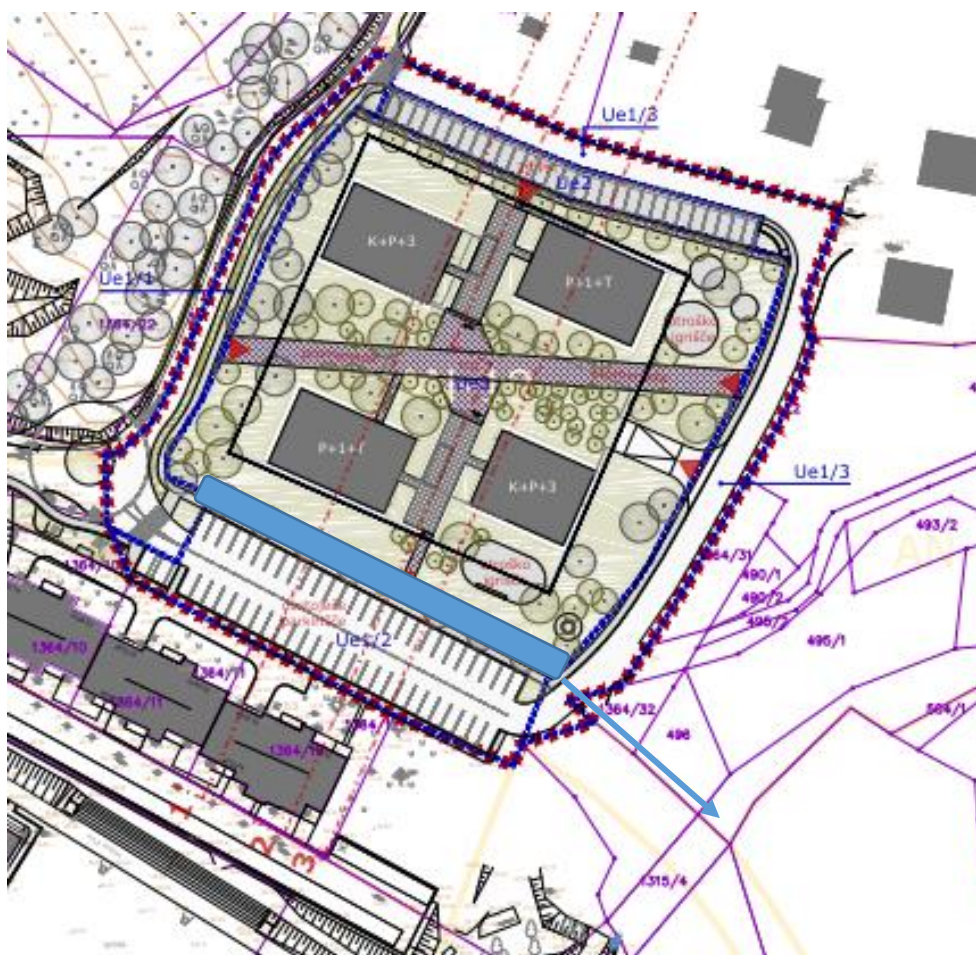
Slika 20: Predlog lokacijske umestitve zadrževalnika označeno z modro
