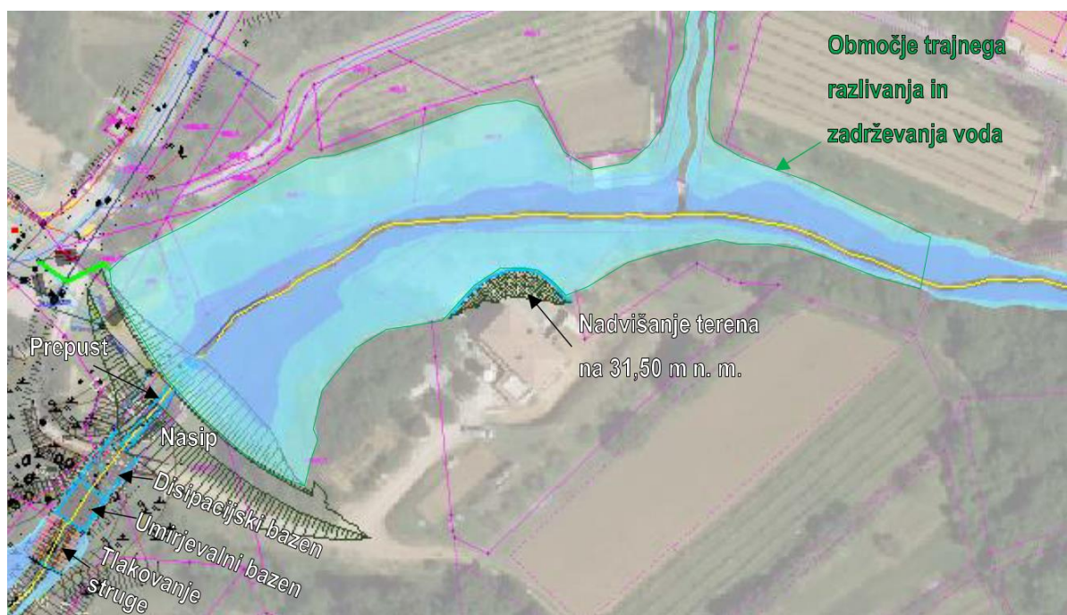
Slika 23: Predvidena ureditev suhega zadrževalnika na hudourniku Ankaran (povzeto po HHŠ Ankaran, PNZ d.o.o., april 2023)
