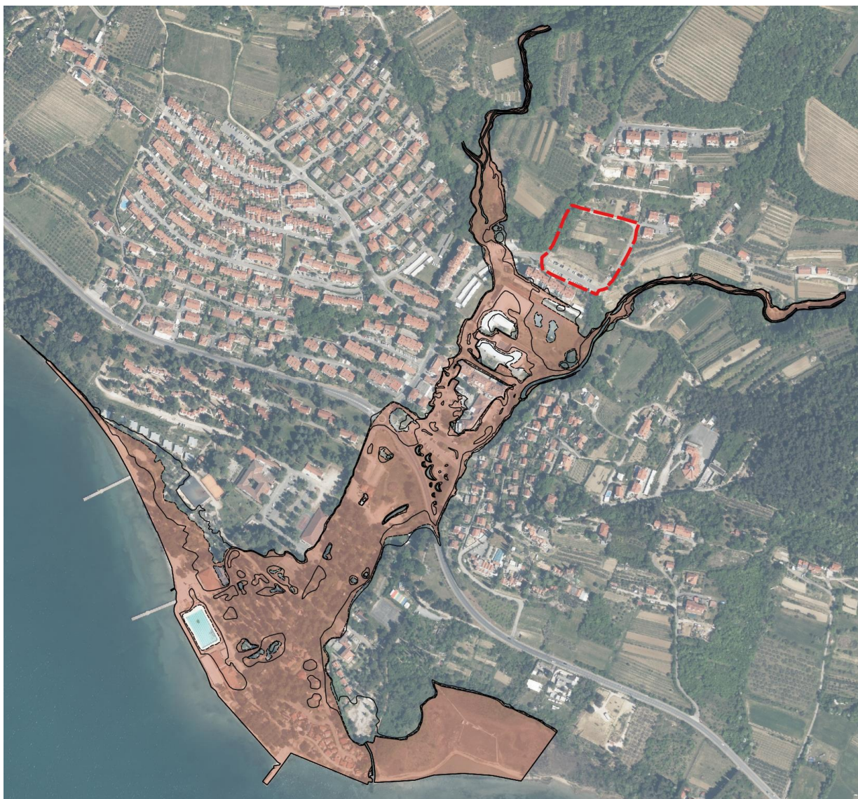
Slika 49: Karta erozijske nevarnosti - debelina oodloženega sloja pri Q_{100}
