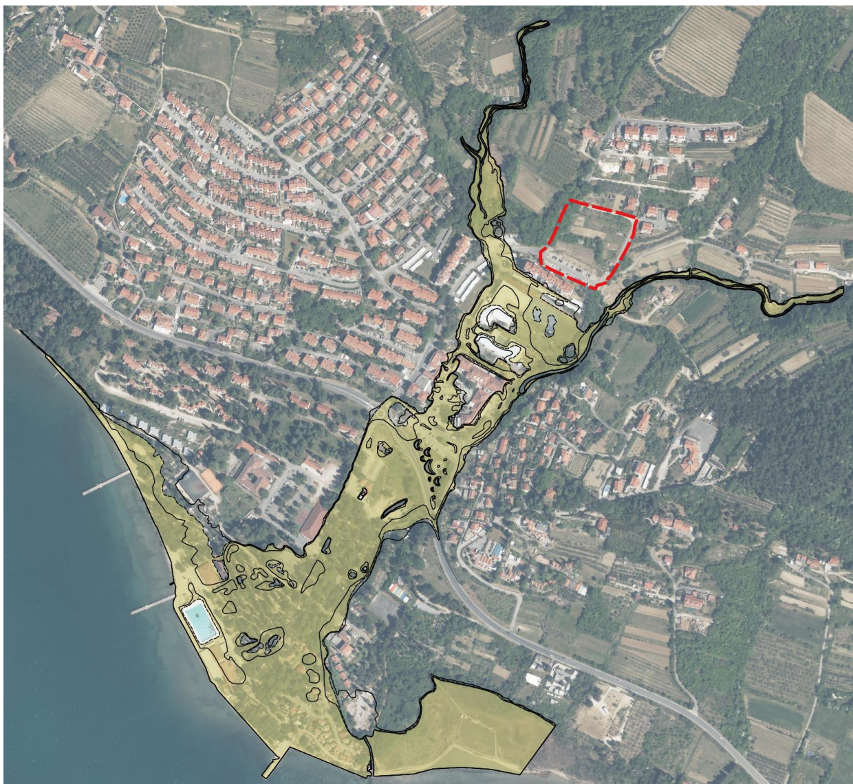
Slika 48: Karta erozijske nevarnosti - debelina odplavljenega sloja pri Q_{100}
